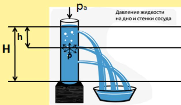
$$p = \rho g h \text{ — давление жидкости на глубине } h$$
